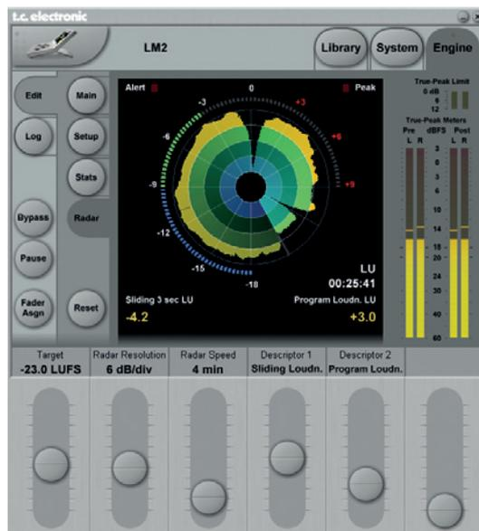
bene Target level von -23 LUFS eingestellt und ergibt die Messung eines Programmsegments einen Wert von -21,0 LUFS, so hebt die Funktion den Ausgangspegel um +2,0 dB an. Mit diesem Offset versehen, kann das Programm nun mit korrekter Loudness über das LM2 in Echtzeit beispielsweise auf einen Server eingespielt werden. Der eingestellte Offset-Wert wird oben im Display angezeigt und kann durch Betätigen der Bypass-Taste jederzeit aufgehoben oder im Menü manuell editiert werden.
